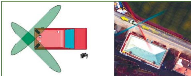
Рис. 3 Схема работы сканирующего блока, использующего технологию iFLEX
